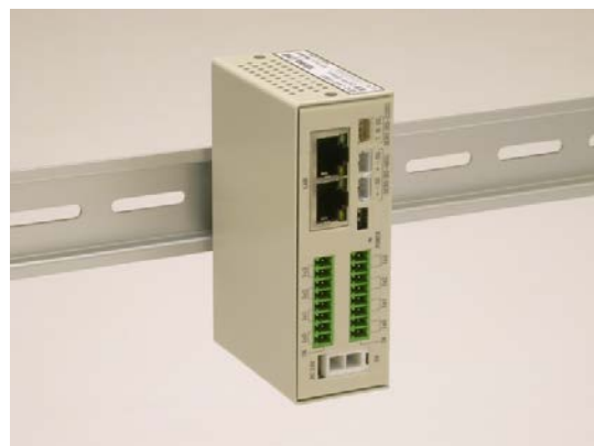
図 14 DIN レールへの固定
