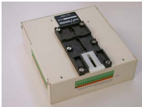
図 2 DIN レール取付具の固定
